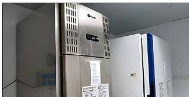
En aquestes neveres, a 80 graus sota zero, emmagatzemem l'ADN de més de 2.000 mostres biològiques d'arreu del món. Foto: A. Montaña
